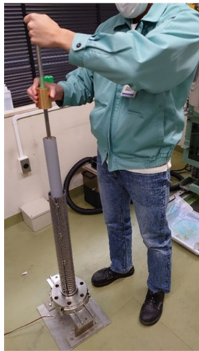
(図 10) 人工供試体作製方法(左:突き固め法、右:多重ふるい法) (出所:機構撮影)
