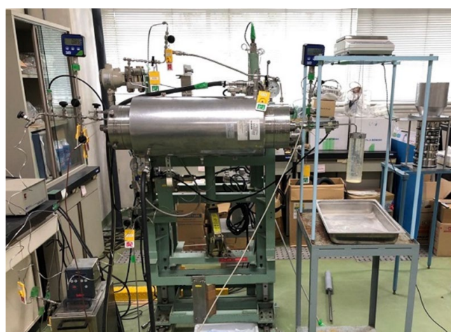
(図 5・左) 出砂シミュレータ概念図(出所:参考文献[3]中の図を加工)
