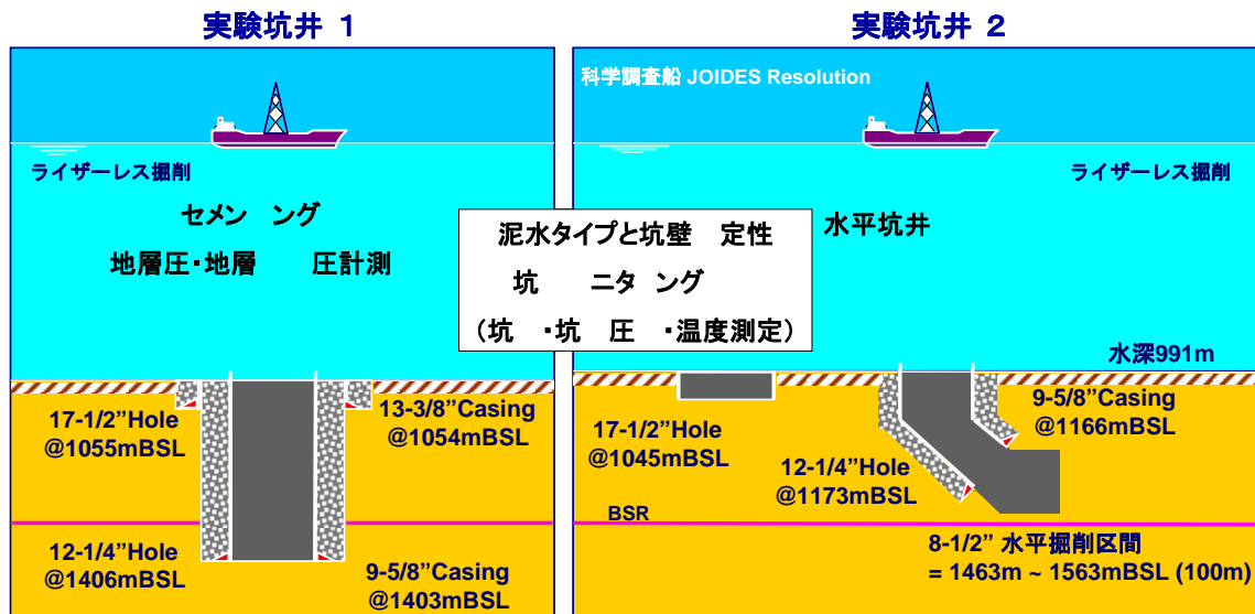
図 8-3 実証試験坑井 1 及び 2 の概念図（BSL=Below Sea Level: 海面下）
