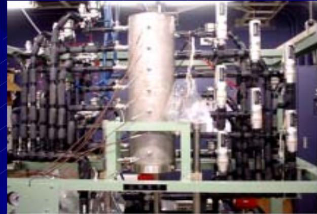
インヒビタ注入法分解評価装置
