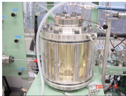
ポリカーボネート製3重管透明容器 直径50mm*長さ200mm 設計圧力 15Mpa
