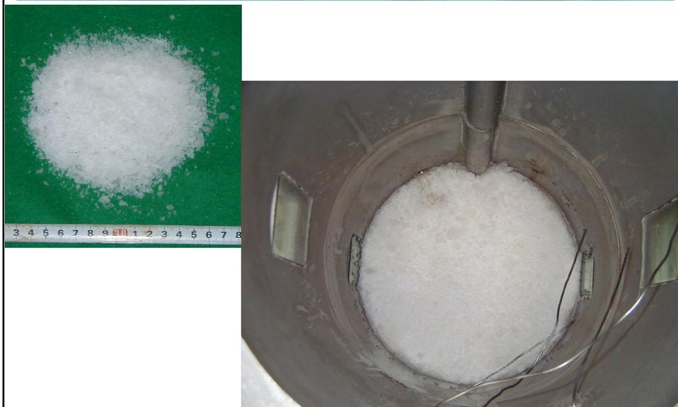
図2.2.4-4 実験土槽内に作成したフロンハイドレート層
