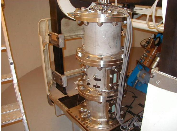
図2.2.4-2 供試体を遠心載荷装置に搭載した状況
