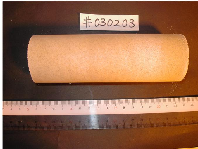
図1.2.3-5 模擬メタンハイドレート堆積物
