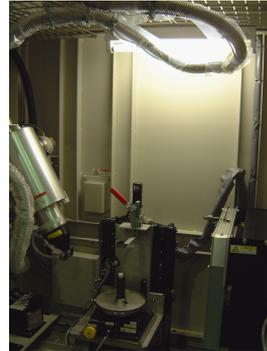
開封管Wターゲット。最大管電圧225kV、管電流1mA、Be窓使用、4inc II。-100℃~100℃温調可能。
