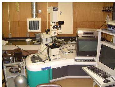
光源からでた光を光学レンズで収束し、被写体表面を高速で走査した際の反射光をCCDで検出することにより、観察視野すべてで焦点の合った試料表面構造を観察できる光学顕微鏡
