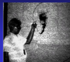
石油・ガス精製工場、化学工場 における漏洩メタンの検知
