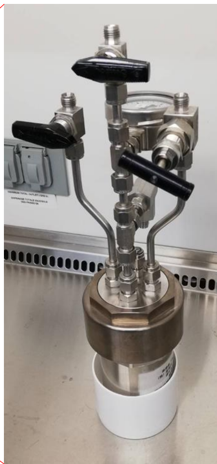
ステンレス製高圧培養容器
