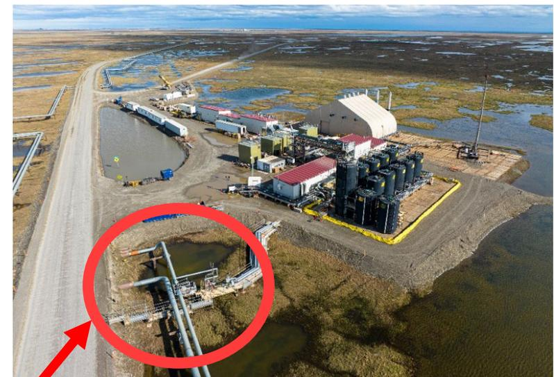
近傍を通るパイプライン(\*)からの試験設備接続部分
