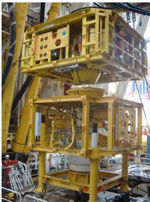
図4 第2回試験のライザー切り離し装置
