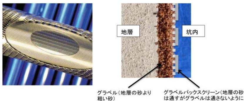
図3 グラベルバックスクリーン(左)とオープンホールグラベルパック仕上げの断面(右)
