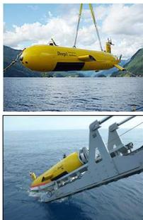
表層ハイドレートが発達していると考えられる上越沖海域において、音響学的ブランキングをとまなう特異点の探索及び詳細構造の把握のため、2013/07/12-30の期間、マルチビーム測深器(MBES)、サイドスキャンソナー(SSS)、サブボトムプロファイラ(SBP)等を搭載した自律型海中探査機(AUV)を使用して、詳細な海底地形・表層堆積層構造の観測を実施。
