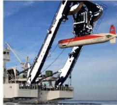
○自立型巡航探査機(AUV) 母船とのケーブルなしで自力で航行し、自動観測する探査機。海底に接近して探査を行い、非常に高い解像度の海底地形や海底下構造のデータを取得することが可能。
