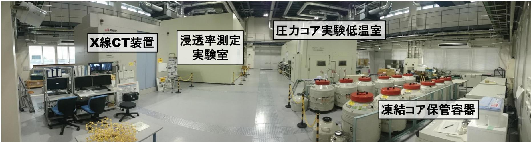
圧力容器内のコアを取出し、X線CT・P波速度・嵩密度の測定を実施⇔船上データと比較
