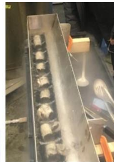
採取された圧力コア試料
