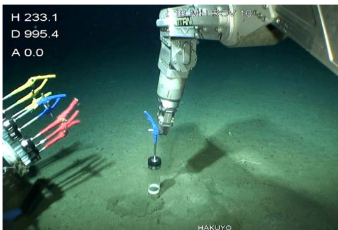
図 13 プッシュコアラによる採泥状況
