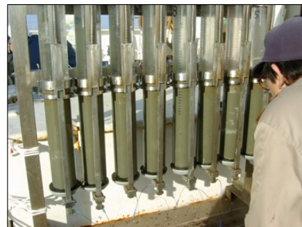
図 10 マルチプルコアラー 左図: 本体 右図: 採取した堆積物
