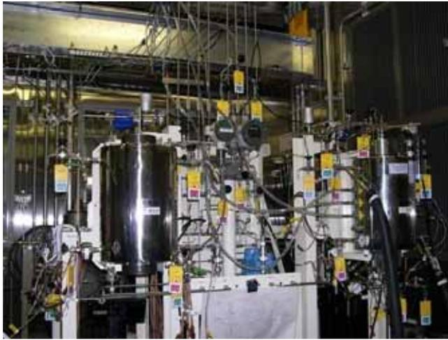
MHコア減圧・加熱分解試験装置
