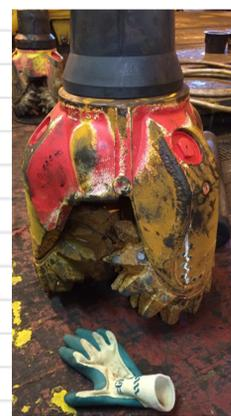
(右) ドリルビット (直径66センチ) とよばれる“ほる”ための装置。先は固い刃がついていて、この刃を回転させて固い岩をほりぬく (ゴム手袋は大きさの比較)
