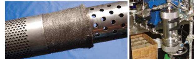
スチールウールタイプのスクリーン(2008年第2回陸上産出試験で使用)
