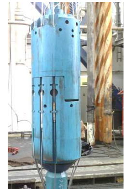
既存の切り離し装置 (Subsea test tree) にケーブルコネクタを収納するスリーブを装着
